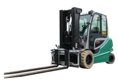
**Tragkraft** 5000 kg Hubhöhe 4,40 m Gabellänge nach Absprache Freihub 1,38 m Länge o. G. / Breite / Höhe 3,20 / 1,41 / 2,23 m Antrieb Batterie Eigengewicht 7600kg Lastschwerpunkt 50 cm
